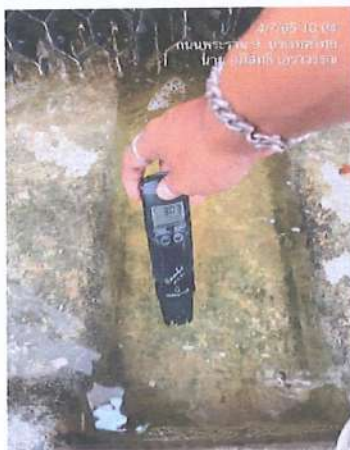
Conductivity Portable Cooling วัดค่าได้ 3030 us/cm
